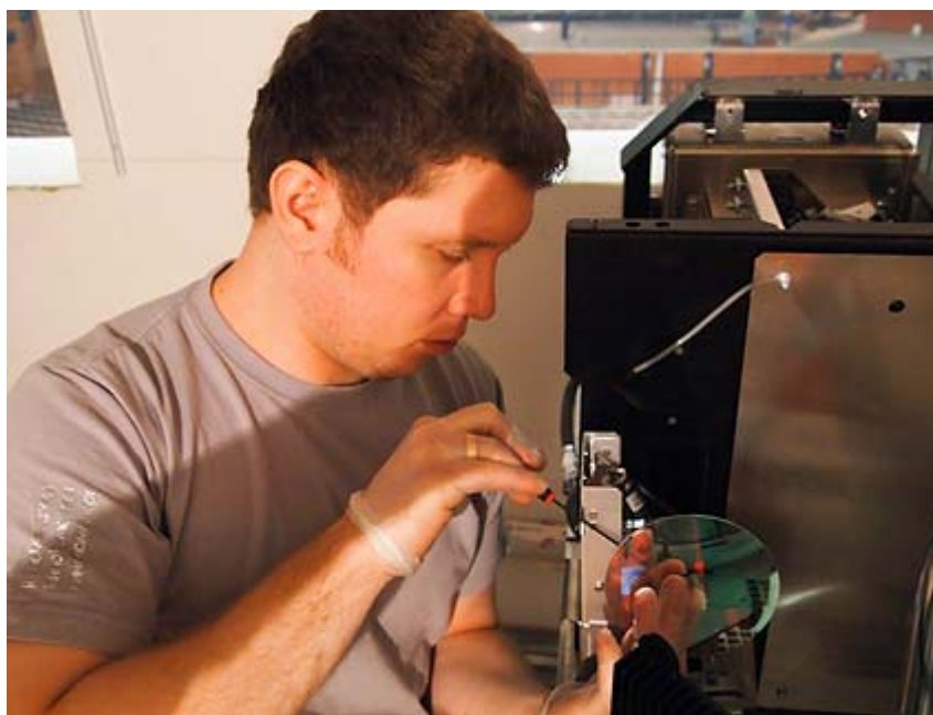
«Ювелирный» монтаж цветowego диска Dolby 3D – по сути, круглой полимерной пластинки с напылением и ценой, равной стоимости автомобиля
