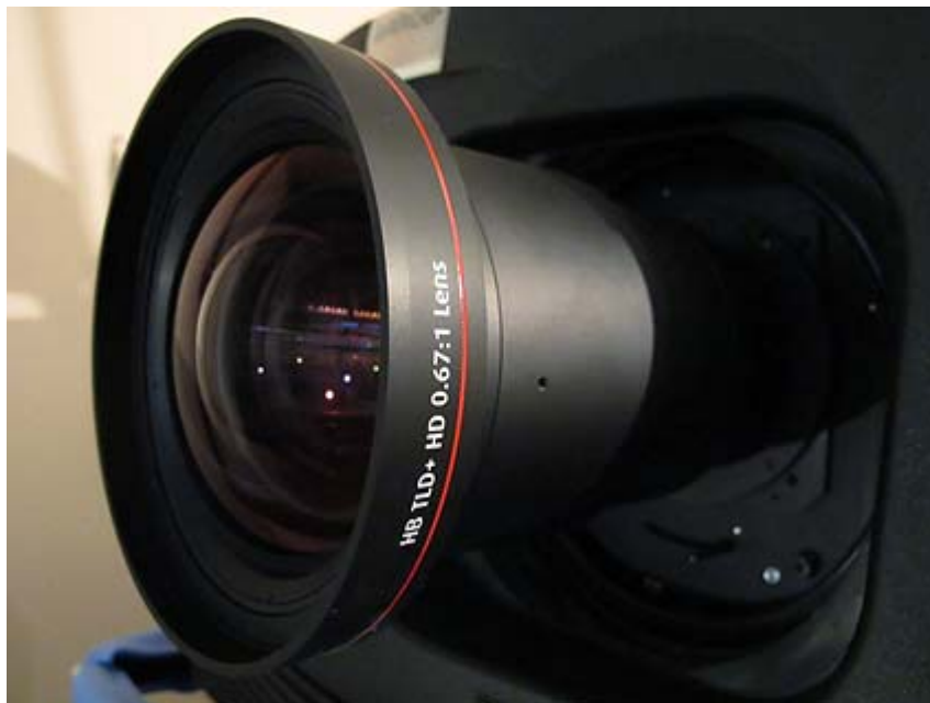
Сверхкороткофокусные объективы «рыбий глаз» для рип-проекции. До экрана немногим более 5 метров
