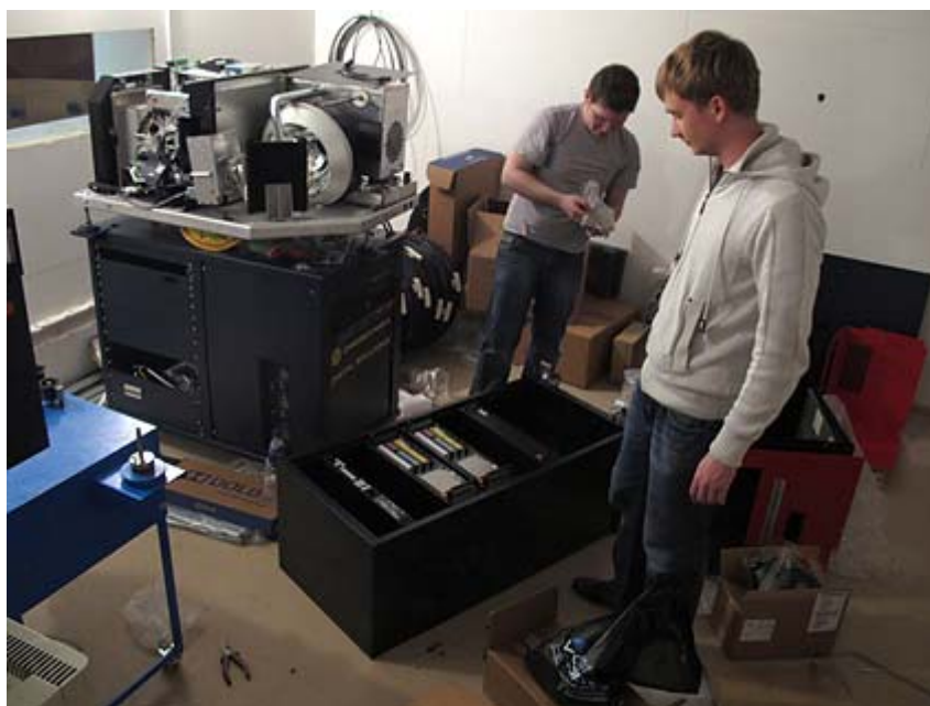
Цифровик Sinetessanica DPC-80 смонтирован и готов к настройке
